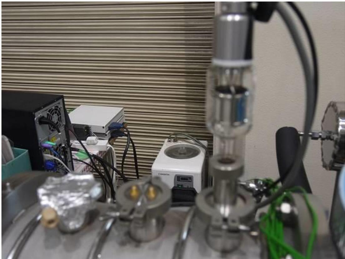
Fig8 : 電離真空計測定子
