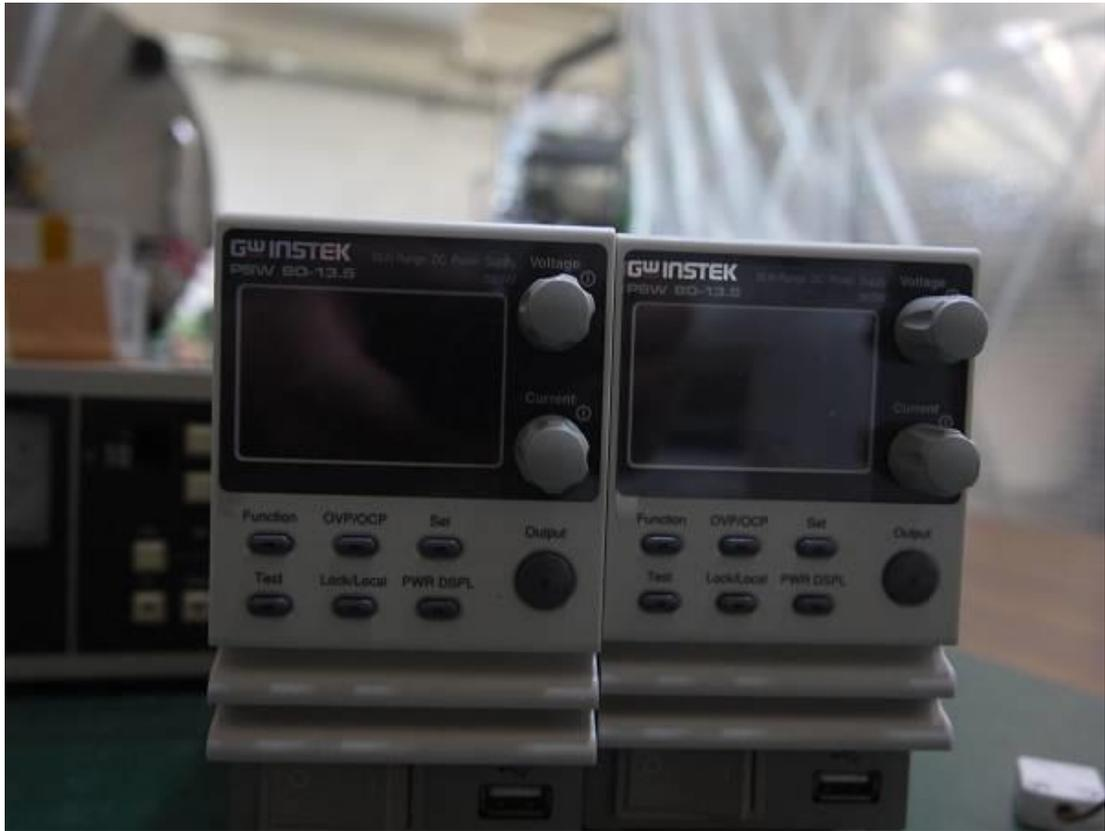
Fig7 : 直流化安定電源
