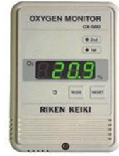
酸素モニター (2Fに設置)
